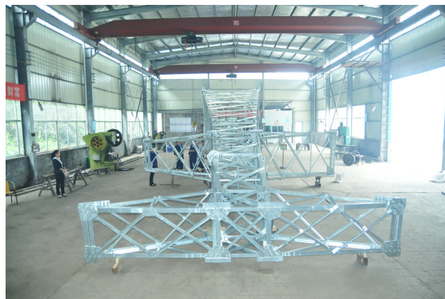
组装待检铁塔
