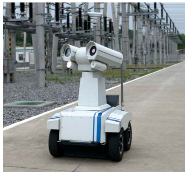
智能机器人进行电力巡检
